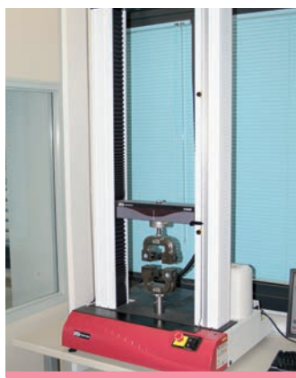
El microdurómetro Shimadzu y la máquina de prueba Instron, en nuestro Centro Bio-Investigaciones Marco Pozzi, utilizados para el control de las características mecánicas de los alambres.
